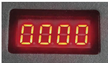
图 3-2 正常运行状态数码管显示内容示意图
