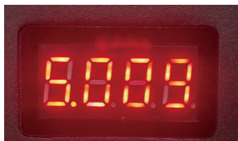
图 3-3 报错状态数码管显示内容示意图
